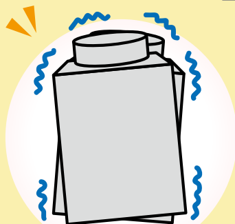
室外機が異常振動している
